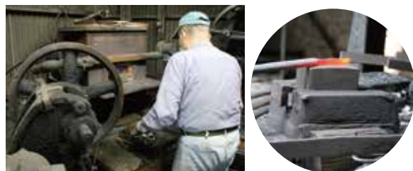
900℃程度まで加熱した鋼材を打つ三代目・中村哲祥氏
